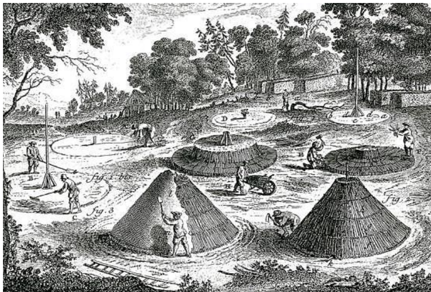
Abb. 2: Herstellung von Holzkohle. Das vorbereitete Holz wird aufgeschichtet, abgedichtet und verkohlt (Duhamel du Monceau, Henry-Louis; 1761. L'Art du Charbonnier ou manière de faire le charbon de bois . Paris: Jean Desaint & Charles Saillant, Planche I. http://www.wsl.ch/fe/oekosystem/insubrisch/projekte/carbonai_ticino/galleria_immagini_1 ; Zugriff: 10.3.2013).
